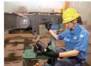
超音波探傷状況
