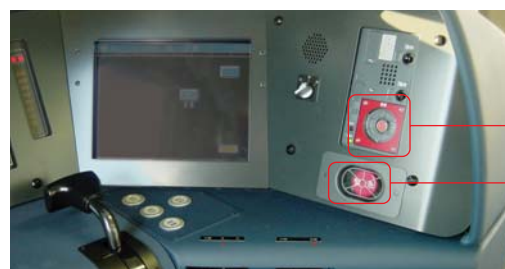
防護用無線機の発報ボタン 緊急列車防護装置のスイッチ
