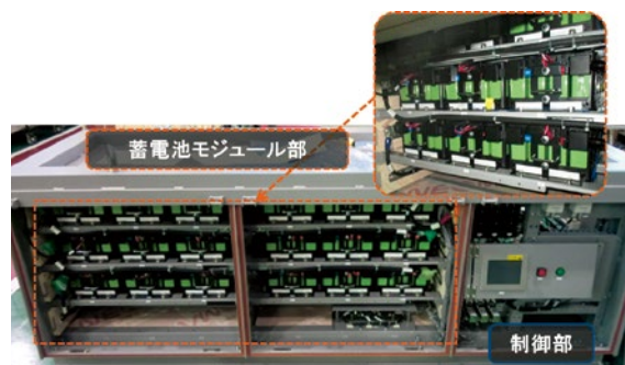
図3：蓄電池システム試作機
