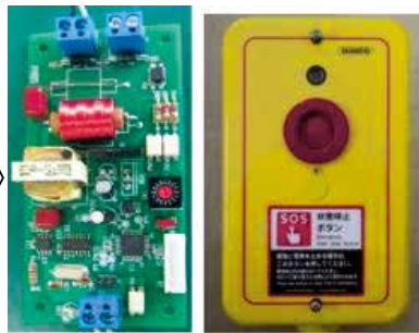
写真2：検知ユニットと列防スイッチ
