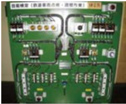
写真1：技能検定用配電盤
