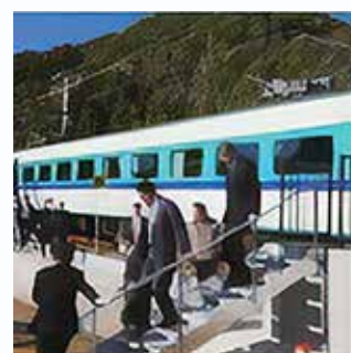
避難誘導降車台
