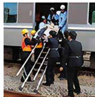
手すり付梯子
