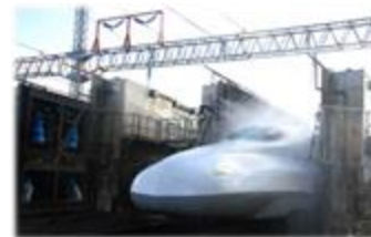
車両洗浄機での雨水活用や循環水の再利用を通じた工業用水使用量の削減
